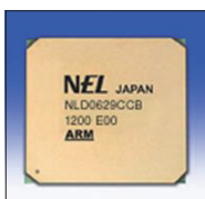
商用化された100Gデジタルコヒーレント信号処理回路 (DSP)
