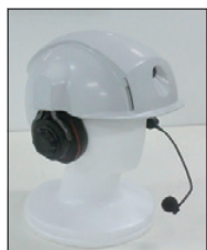
ヘルメットに埋め込んだヘッドセット型インテリジェントマイクの実装例
