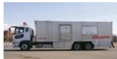
通信ビル用 大型移動電源車
