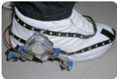
発電機能を搭載した試作靴
