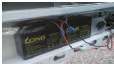
自動販売機内部に設置されたONU、バッテリーと電源選択回路
