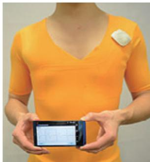
“hitoe”を使用した生体情報計測用ウェアで心拍数・心電波形を計測
