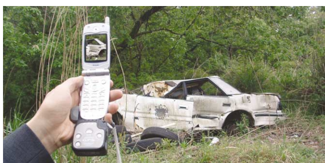
カメラ付き携帯電話で廃棄物を撮影し、GPSで位置情報をネット上に登録
