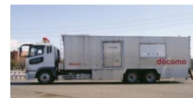
通信ビル用 大型移動電源車
