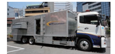
通信ビル用大型移動電源車
