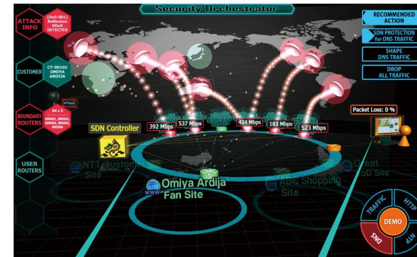
SDNコントローラが各境界ルーターと標的サイト至近の収容ルーターを連動させることで攻撃トラフィックのみの遮断を実現
