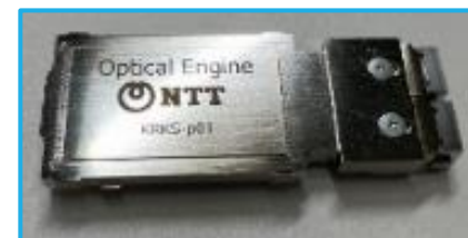
NTT光エンジン (光電融合デバイスPEC-2)
