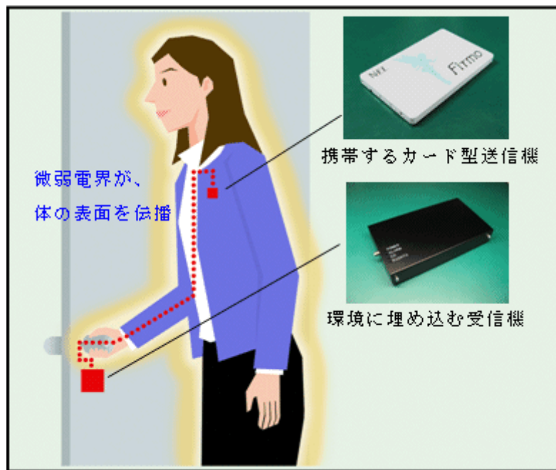
図1 レッドタクトンの通信イメージ
