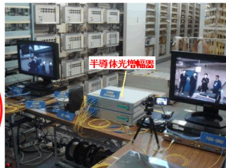
図1 フィールドトライアルの場所と光半導体増幅器
