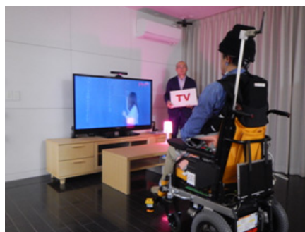
BMIによる生活機器操作の実験の様子
