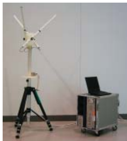
携帯電話基地局の電波を測定する電波強度測定装置と受信アンテナ部
