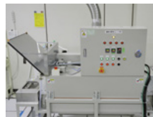
過熱水蒸気炉
